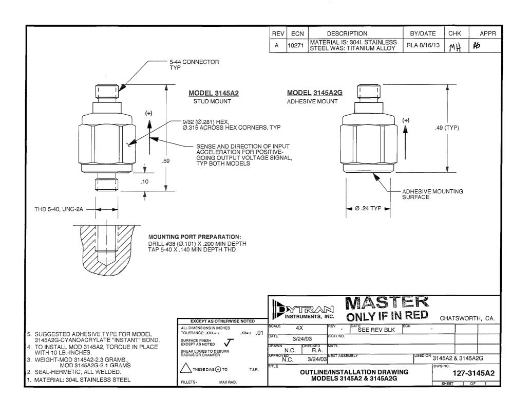
**Model Number** DOC NO PERFORMANCE SPECIFICATIONS 3145A2G PS3145A2G IEPE ACCELEROMETER REV C, ECN 11062, 112/15/15
